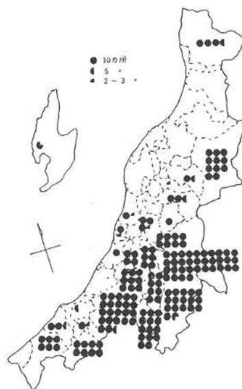
図-1 郡市別なだれ防止工事施工ヶ所数 (昭和52年現在)
