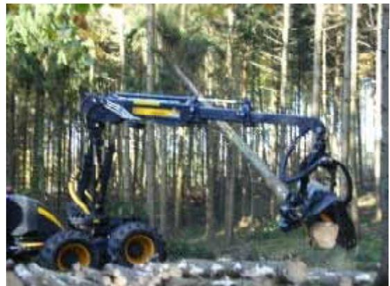
写真18 ハーベスタによる伐木・造材作業
