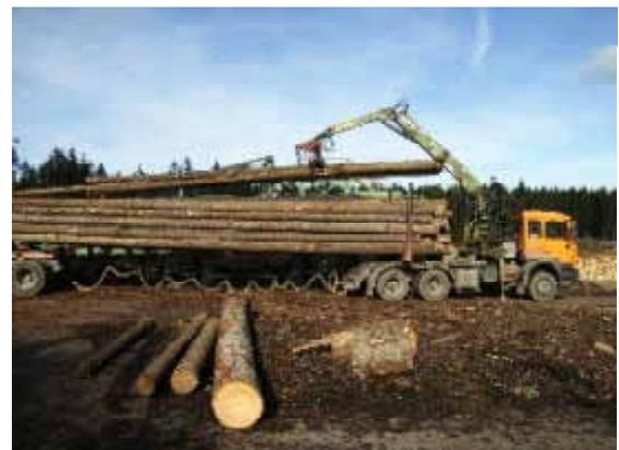
写真22 トレーラーで運ばれた長さ21mの原木の積み降ろし作業
