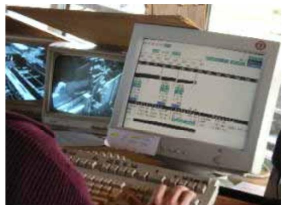
写真23 オペレーターが眺めるコンピューターの画面。自動計測された幹の形状が写し出されている。瞬時に採材位置を決めて、入力していく。
